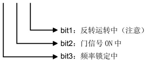
注意: 停止中的“反转运转”bit 是通过上一次的运转状态变化的。在有必要准确识别正转运转中、反转运转中的场合, 请同时确认“门信号 ON 中”bit 的状态。
